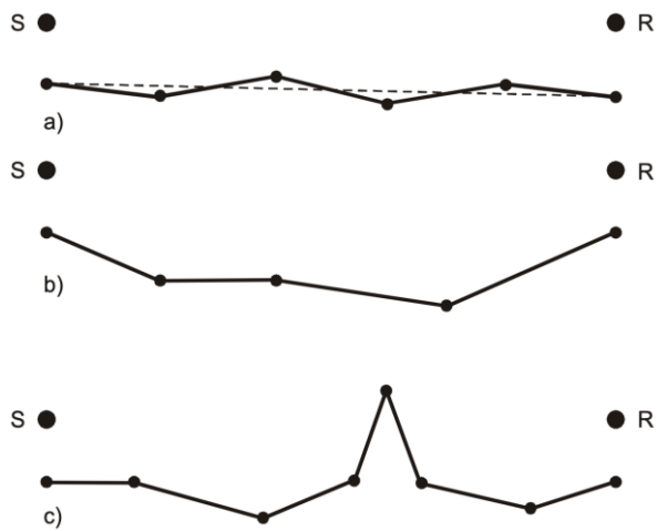
Figur 3. Exempel på segmenterad terräng: a) praktisk taget platt terräng, b) dalformad terräng, c) kulleformad terräng. S = source, R = receiver.
